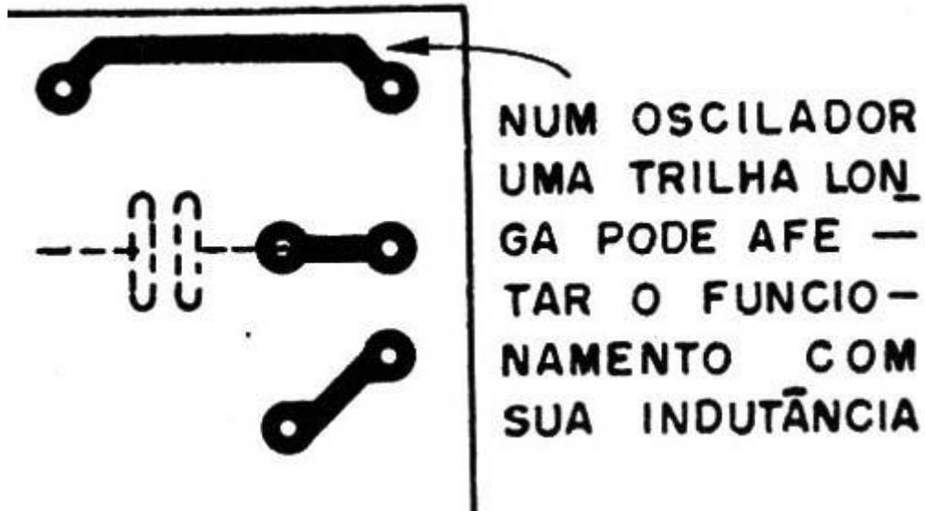
Como sabemos, uma bobina representa uma oposição à passagem de um sinal de alta frequência, prejudicando assim o funcionamento do circuito. Em outras palavras, nos circuitos de altas frequências ou de pré-amplificadores de áudio e outros de alta impedância, é preferível, às vezes, usar um jumper do que fazer uma trilha longa (fig.11).
