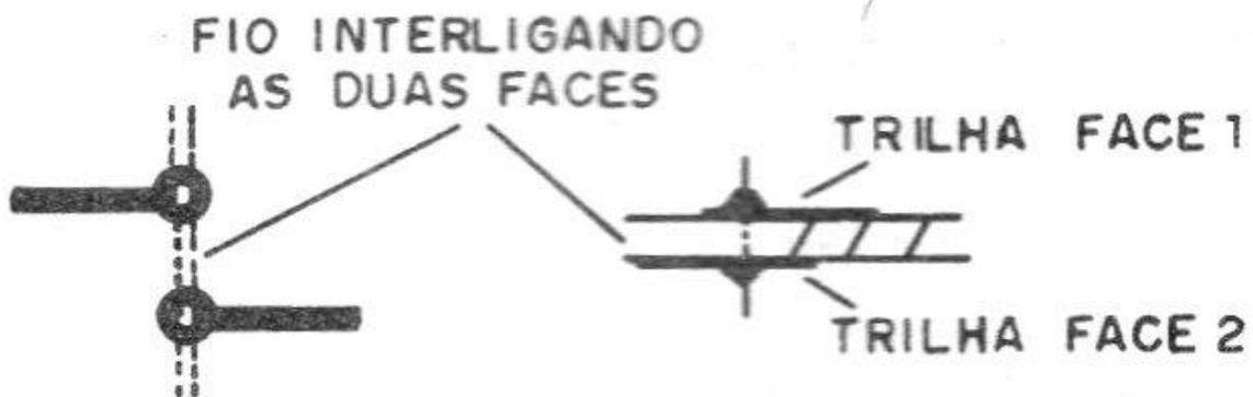
Nas placas de desenho industrial, como as usadas em montagens digitais complexas, computadores, etc..esta passagem pode ser feita através de furos metalizados.
